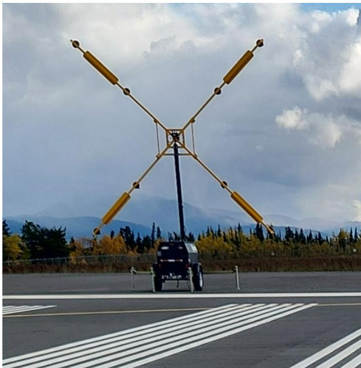
Figure 4 – X illuminé indiquant une fermeture de piste
