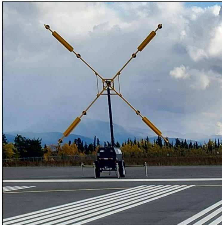
Figure 4. X illuminé indiquant la fermeture de piste
