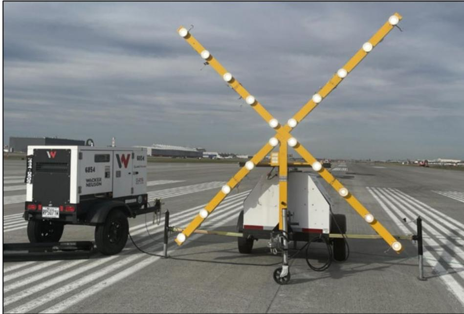
Figure 1. Balise éclairée de zone fermée en « X »
