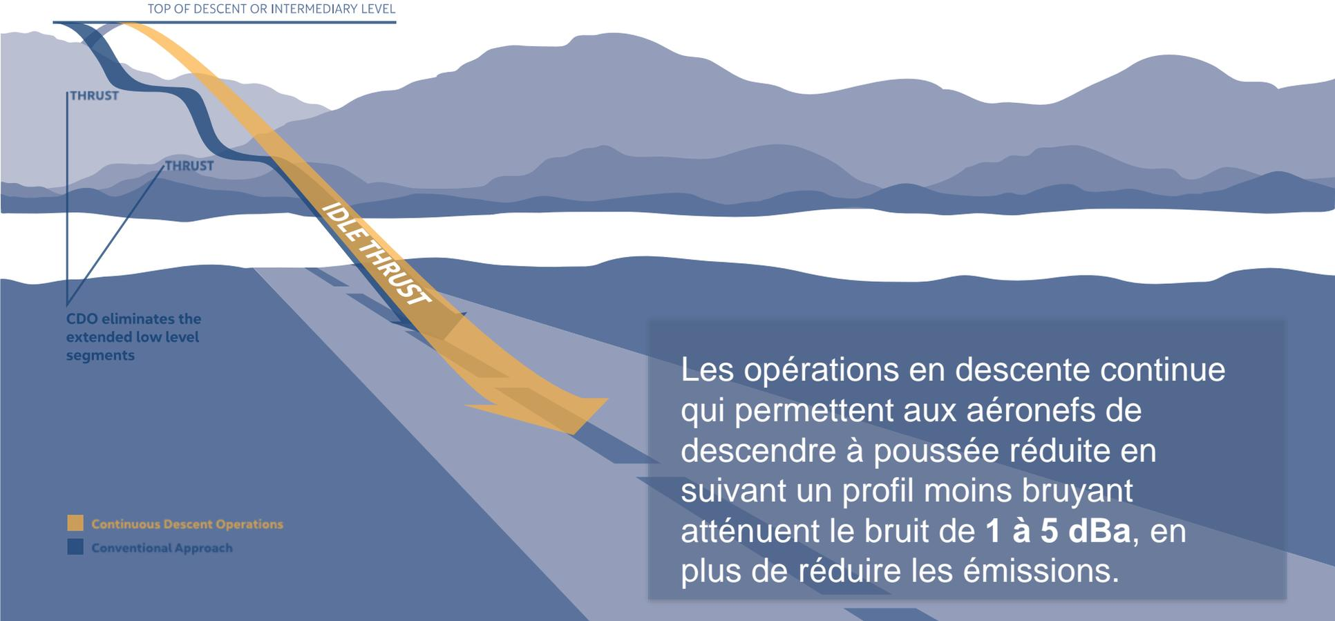
Les opérations en descente continue qui permettent aux aéronefs de descendre à poussée réduite en suivant un profil moins bruyant atténuent le bruit de **1 à 5 dBa**, en plus de réduire les émissions.
