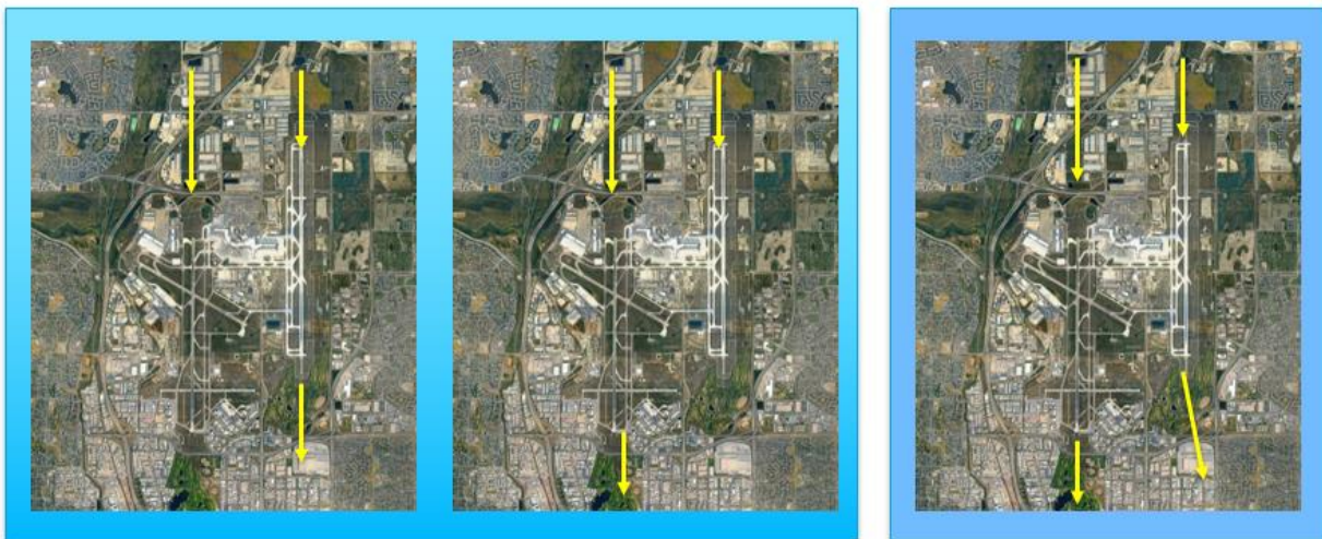
Figure 1 : L'aéroport de Calgary fonctionne selon l'un des deux modes suivants pour les arrivées et les départs sur les pistes parallèles :
