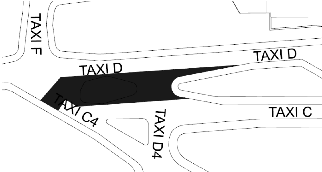
Figure 6 : Phase 2, travaux de construction de la voie de circulation CHARLIE (zone 2)
